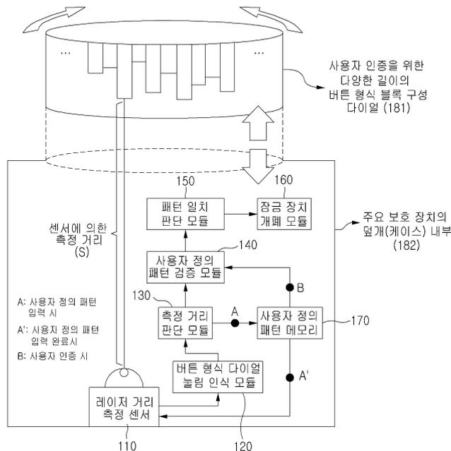
및 제어하는 잠금 장치 개폐 모듈, 버튼 형식의 블록 구성 다이얼이 눌렸는지 여부를 판단하는 버튼 형식 다이얼 눌림 인식 모듈, 사용자 정의 인증 패턴을 저장하는 사용자 정의 패턴 메모리, 레이저 거리 측정 센서에 의해 측정되는 블록 구성 다이얼에 구성되어 있는 상이한 길이의 블록들과 레이저 거리 측정 센서 사이의 블록-센서 간 거리 값을 측정 및 판단하는 측정 거리 판단 모듈, 측정된 블록-센서 간 거리 값과 사용자 정의 인증 패턴을 비교 및 분석하여 검증하는 사용자 정의 패턴 검증 모듈 및 사용자가 정의한 모든 패턴이 일치하였는지를 판단하는 패턴 일치 판단 모듈을 포함한다.
